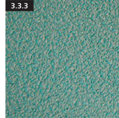
Нанести на подготовленную поверхность при помощи терки, выровнять и дать подсохнуть в течение 10–20 минут.
