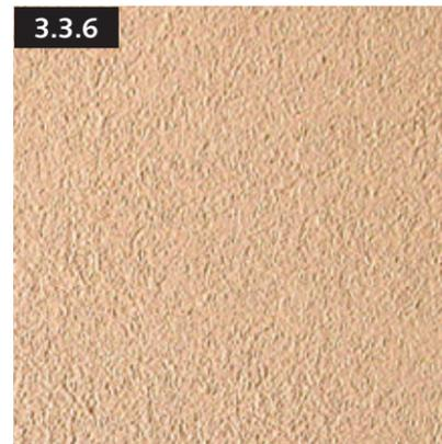
3.3.6 Круговыми движениями полиуретановой терки растереть подсушенную штукатурку до получения равномерной зернистой поверхности.
