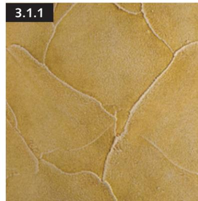
3.1.1 Наносить на подготовленную поверхность при помощи кельмы слоем 1–3 мм. Сразу же после нанесения выровнять поверхность, удаляя излишки рельефной шпатлевки. Декорировать кельмой, шпателем.
